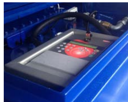
Le système DiaLOG installé sur un réservoir mobile
